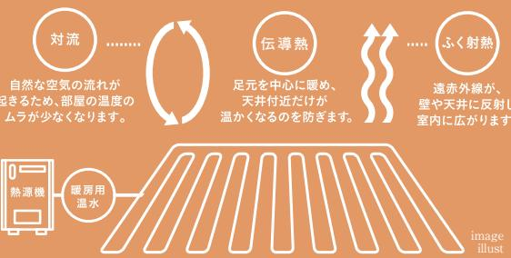
快適・安心な住まいを実現する温度のパリアフリー。ガス温水式床暖房とは、熱源機で加熱した暖房用の温水を、暖房用のポンプでお部屋に設置した床暖房に循環させ、その熱を利用して暖房する仕組みです。※リビング・ダイニングのみ
