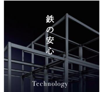
柱と梁を一体化した鉄骨ラーメンユニット構造で、建物全体をしっかりと支え、高精度な品質と耐久性を高い水準で維持します。地震に強く、将来のメンテナンス負担も軽減。住宅の基盤となる確かな構造品質が、安心して暮らせる毎日をお届けします。
